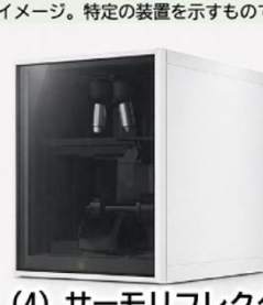
(4) サーモリフレクタンス 熱物性測定装置 (薄膜・微小粒子・ 微小構造の熱伝導)
