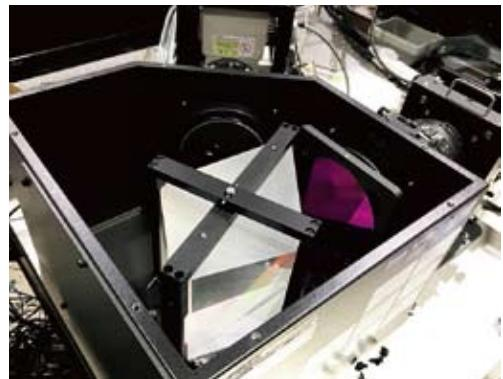
図2 グレーティング（回折格子）とプリズムで構成される光学素子「グリズム」、CMOS高速カメラ、イメージインテンシファイアを用いた最先端の分光計測装置
