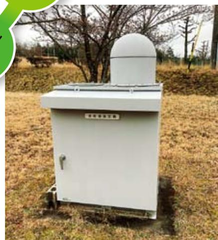
放射線監視装置(モニタリングポスト)により敷地境における環境放射線を測定・監視し、測定結果を公開しています。
