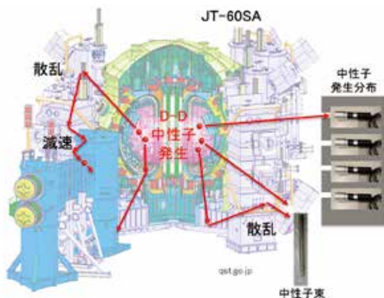
図2 高エネルギー粒子閉じ込め研究のための高性能中性子計測
