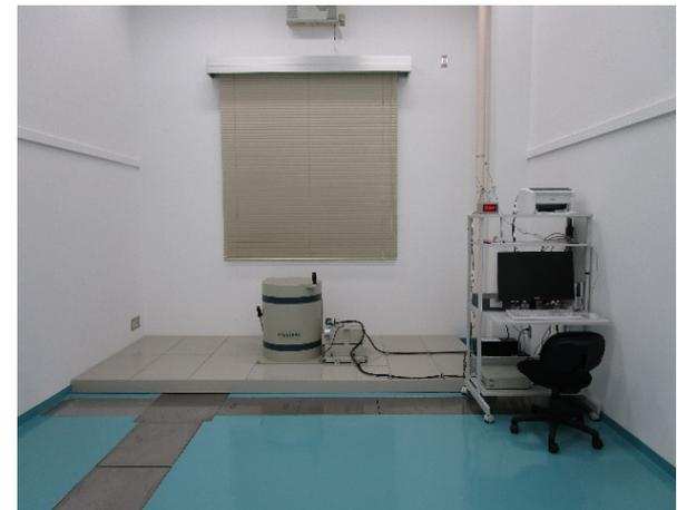
管理区域内の精密なガンマ線測定のため、可搬型高純度ゲルマニウム (HPGe) 半導体検出器を新たに整備しました。(平成30年2月23日)
