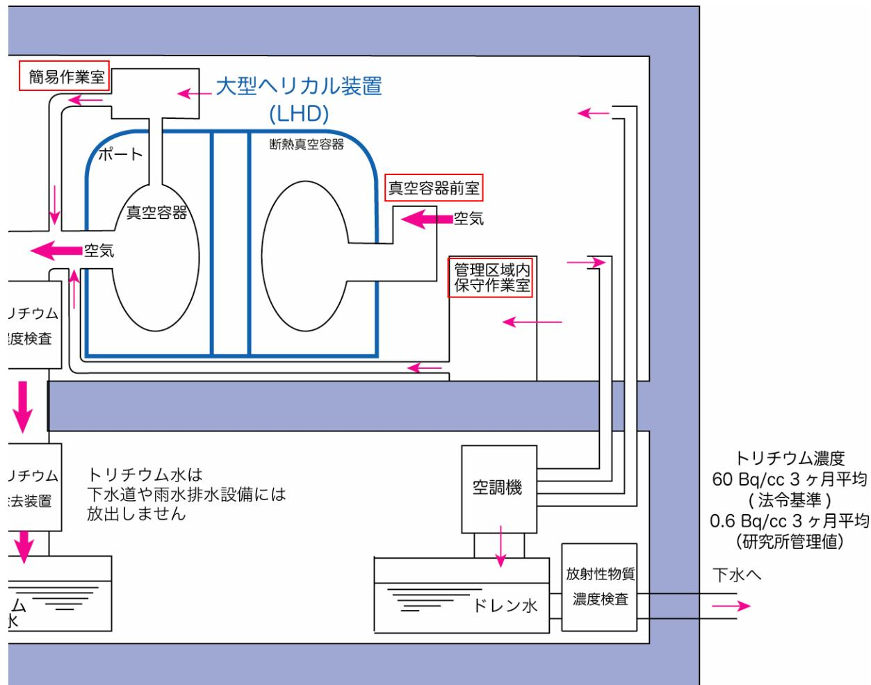
真空容器から本体室へわずかに漏出するトリチウムは、空調機を通して循環する。
