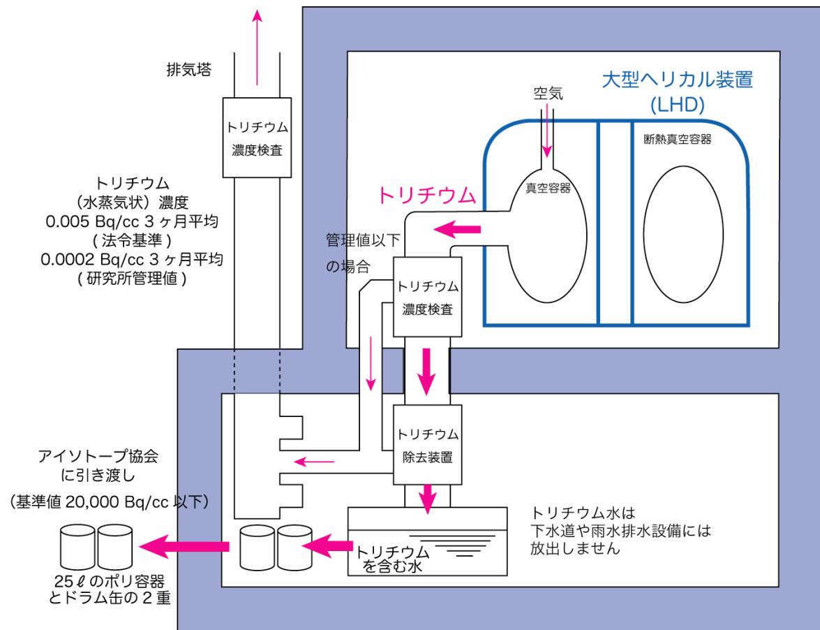
換気されたガスはトリチウム濃度検査を行い、研究所管理値を越える場合は、トリチウム除去装置に導き、水の形で除去・回収
