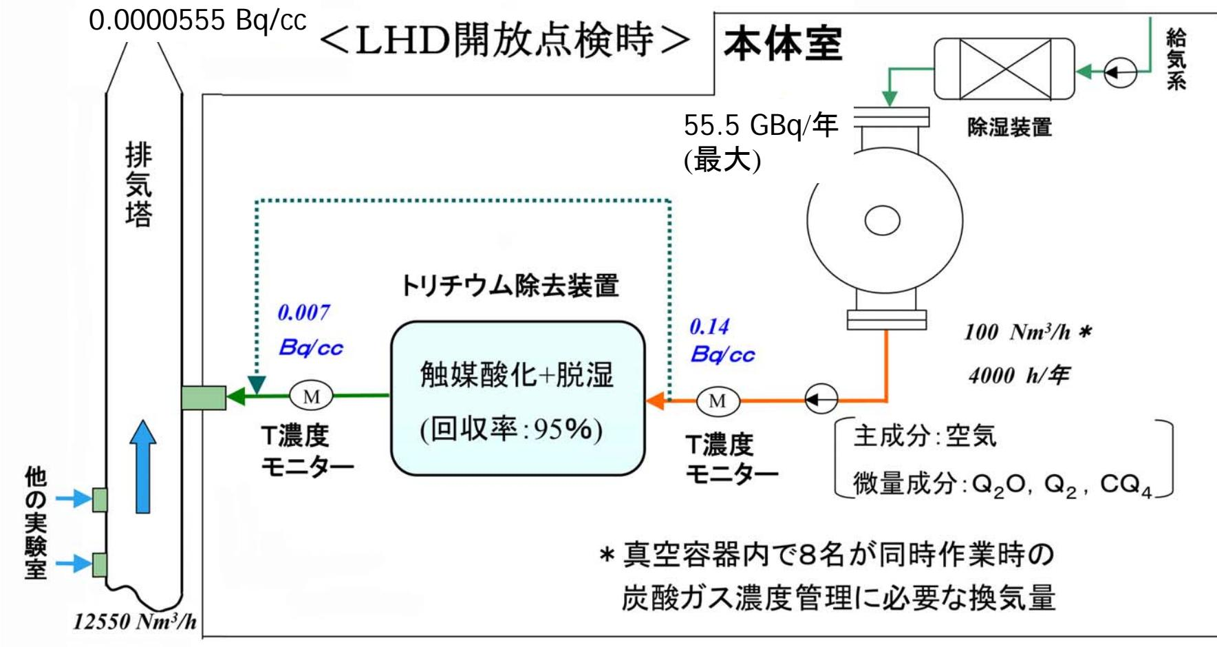
大気開放後の排気など、排気量の大きい排気時にも、使用
