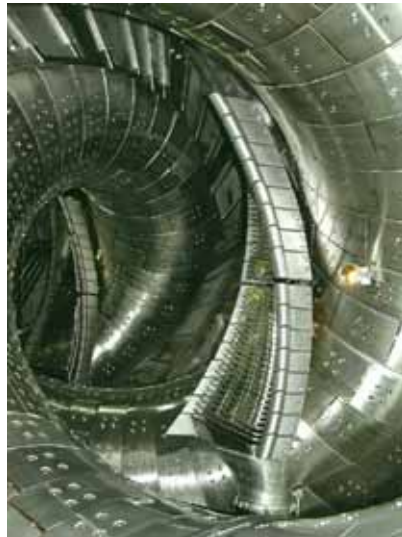
図 2.2-37 真空容器内に設置された ICRF ループアンテナ
