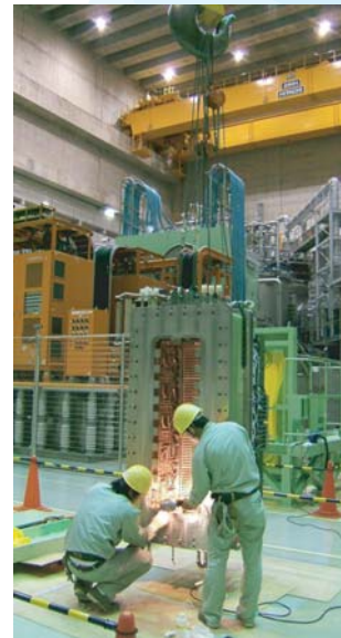
負イオンビーム源を取り付ける前の最後の点検。人の背丈ほどの大きさがあります。手前の開口から水素ビームが出てきます。
