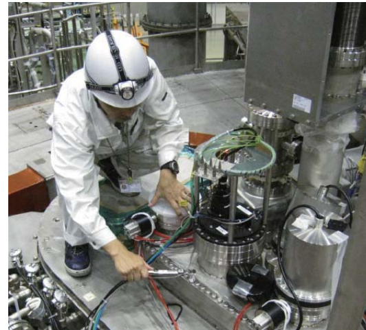
装置内部を真空中にした時に空気が入らないよう、厳重にふたをします。どんな小さな「すきま」も許されませんので、しっかりと、ネジをしめます。
