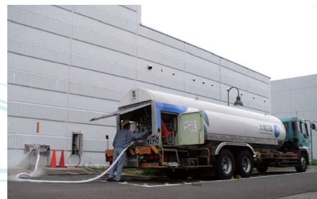
ヘリウムを冷やすための液体窒素は、タンクローリーで運ばれてきます。多いときには、1日に12台のタンクローリーがやってきます。
