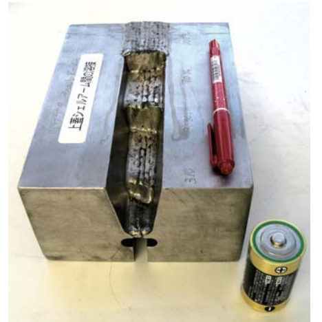
LHD内の溶接部の説明用模型 厚さ10センチもある板を何度も繰り返し溶接していきます。一番手前が溶接を始めた状態で、奥に向かって30%、70%、100%完了した状態です。
