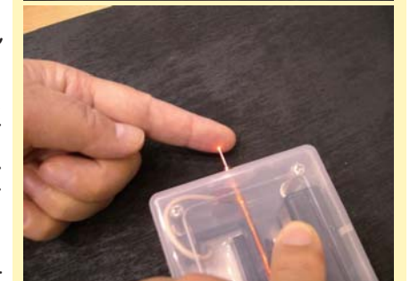
指で触ることができるプラズマ。殺菌作用を利用して医療分野への応用が期待されています。
