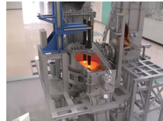
ささゆりクリーンパーク（可児市）に導入されたプラズマ式溶融炉（模型） 黒い棒の先端で光っているのがプラズマの光
