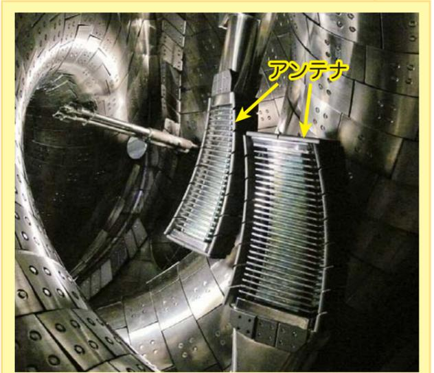
新しくLHDに取り付けた電波加熱装置のアンテナ
