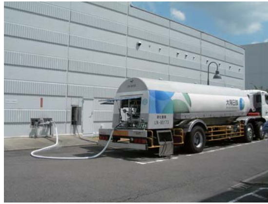
液体窒素はタンクローリで運ばれてきます。
