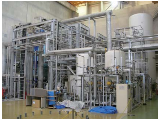
国内最大のヘリウム冷凍機です。液体窒素は右奥の背の高いタンクに貯めます。
