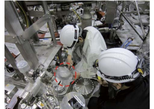
真空テストの様子。点線で囲まれたポートをビニール袋でおおい、その中にヘリウムガスを入れて真空テストを行います。ヘリウム検知器をモニターしている人と無線機で連絡を取りながらヘリウムガスを入れます。
