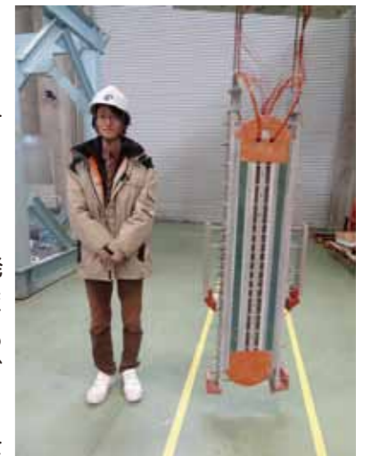
10万アンペアを流した大電流・高温超伝導導体サンプル
