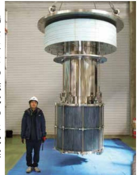
研究所で新たに開発された大口径高磁場超伝導コイル
