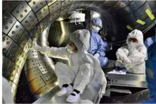
ドーナツ形状の真空容器の内側には、ヘリカルコイルと呼ばれる超伝導電磁石の入った壁が、らせん状に張り出しています。これを乗り越えて人が移動するのは大変なので、メンテナンスの最中は、横幅40センチメートルの橋が直径約8メートルのドーナツに沿って空中に架けられています。橋の上はちょうど、1億度近いプラズマが実験中に浮かんでいる位置です！見学者はチリやホコリを落とさないようにクリーンルームウェアを着て、真空容器の中を見て回りました。ステンレスでできた壁に直接触れると、金属特有のひんやりとした感覚を体験できます。日常とは異なる空間の中で、時間が経つのを忘れ、写真を撮ったり、熱心にメモをとったりする姿がみられました。
