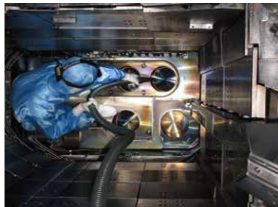
真空容器の清掃作業の様子
