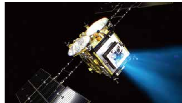
イオンエンジンを使って小惑星リュウグウに向かう「はやぶさ2」 (C) 宇宙航空研究開発機構（JAXA）
