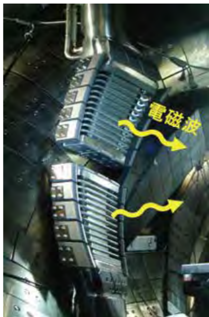
LHDに設置されているイオンサイクロトロン共鳴加熱 (ICH) 用アンテナ
