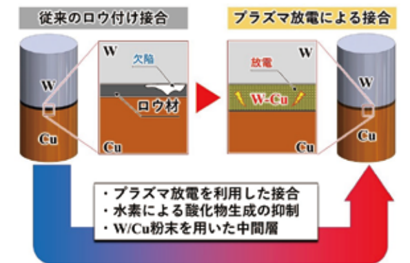
従来のろう付け接合法（左）とプラズマを用いた接合法（右）の違い
