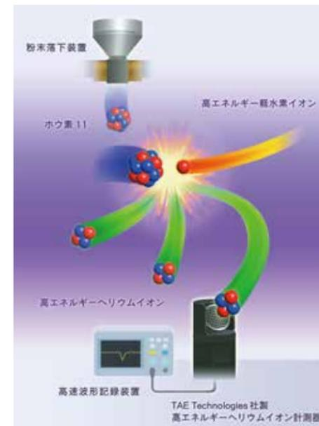
時速1,500万キロメートルを超える速さの軽水素イオンと、粉末落下装置によってプラズマ中に落下させたホウ素を使って、核融合反応を起こし、その生成物の高エネルギーヘリウムイオンを検出する原理図
