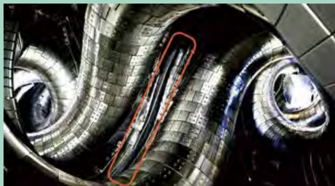
真空容器内部の様子。赤線で囲んだ部分に炭素板が使われています。
