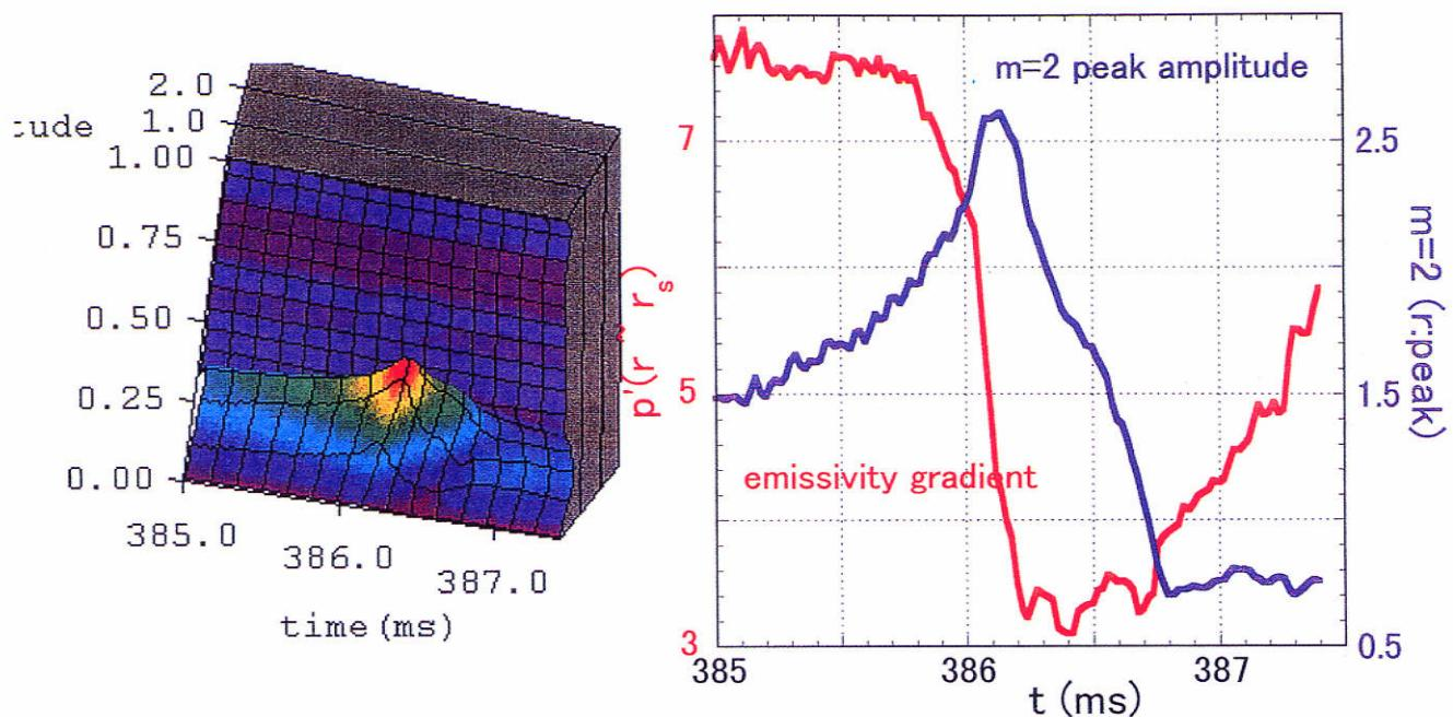
この例では内部崩壊時に $m=2$ の変形が急激に増大し分布の大きな変化を引き起こす。
