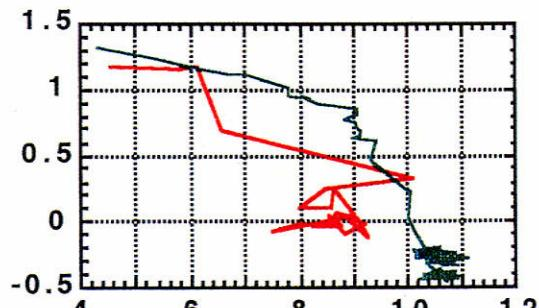
図 2  $m=2$  モードの対数振幅 (Y 軸) と勾配 (X 軸) を典型的な二つの放電に対してプロットしている。
