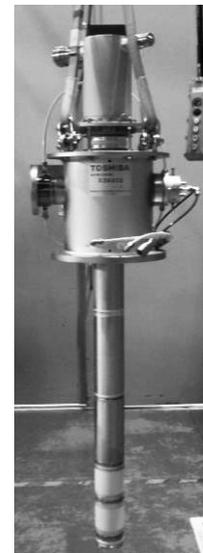
Fig. 2 Picture of the fabricated actual gyrotron.
