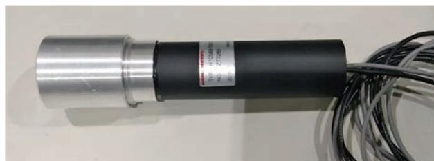
Fig. 2  $\text{LaBr}_3\text{:Ce}$  scintillation detector
