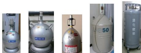
図1. 利用されているLN<sub>2</sub>運搬・保存容器類
