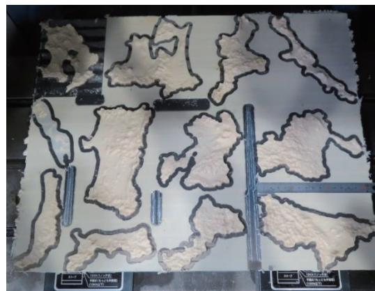
図9 外周輪郭加工後12県 縦400mm 横500mm
