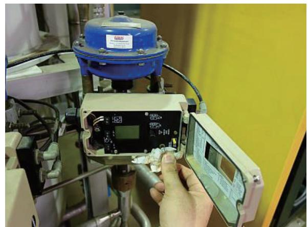
図 1. 故障した圧力制御弁ポジショナー
