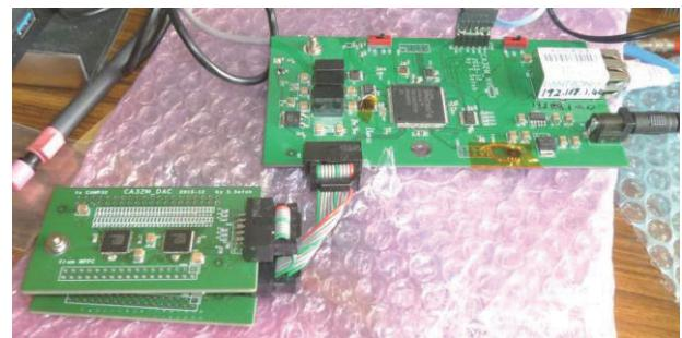
図 7. MPPC 電圧制御回路
