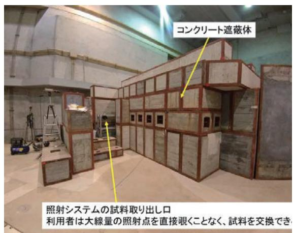
図 1. 照射点を取り囲むコンクリート遮蔽
