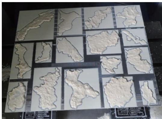
図8 外周輪郭加工後16県 縦400mm 横500mm
