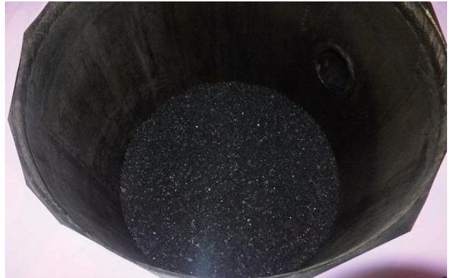
図 1. 油分離器の内部(4 次セパレータ)
