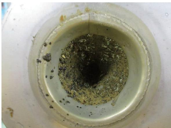
図6. ストレーナー内部の汚れ
