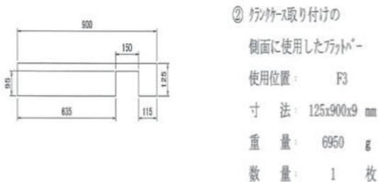
図5. 補強板（内側）図面
