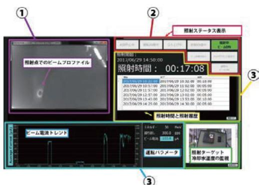
図 5. 加速器・ビーム照射状況表示モニタ
