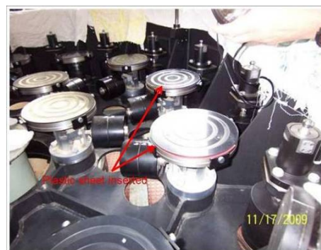
写真 6. シートの挿入
