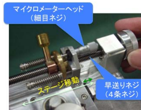
図 12 X 軸移動機構
