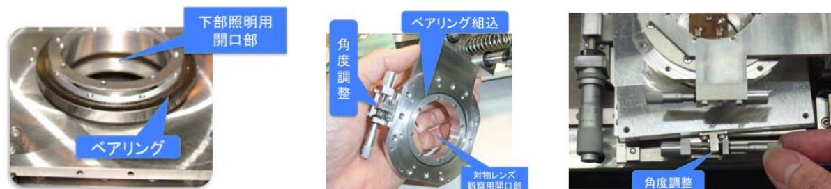
図 8 超薄型ベアリング使用例
