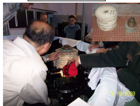
写真 9. 各パッドの圧力調
