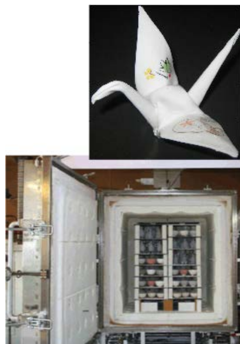
図 3 セラミック折り紙（上） とマイクロ波焼成窯（下）
