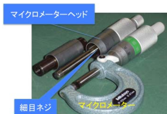
図 11 マイクロメーターヘッド (細目ネジ)
