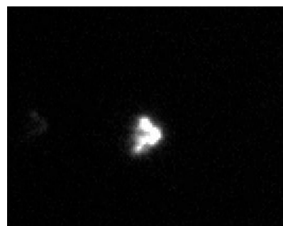
写真 10. 望遠鏡位置変化による星像移動
