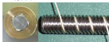
図 10 標準ネジと 4 条ネジ
