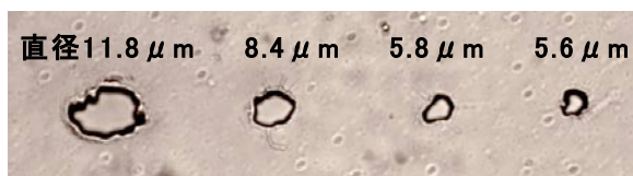
図 6. UV レーザーのフォーカス調整
