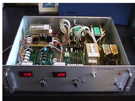
図4. バイポーラ高電圧パルサーの外観とパルス出力波形
