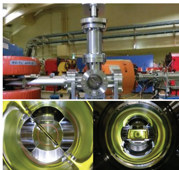
図6 YAG スクリーン 左：横から 右：下から
