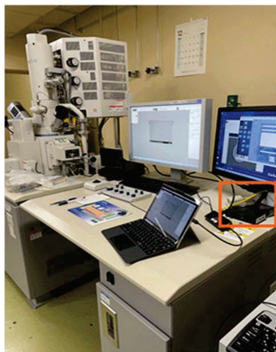
図 3 リモートシステム設置状況
