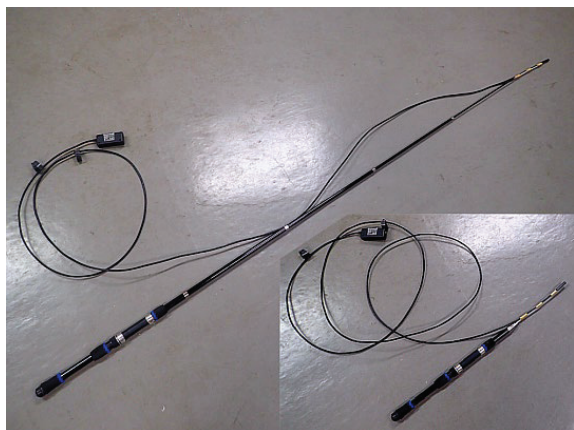
図 8 釣り竿を補助具にして内視鏡を操る
