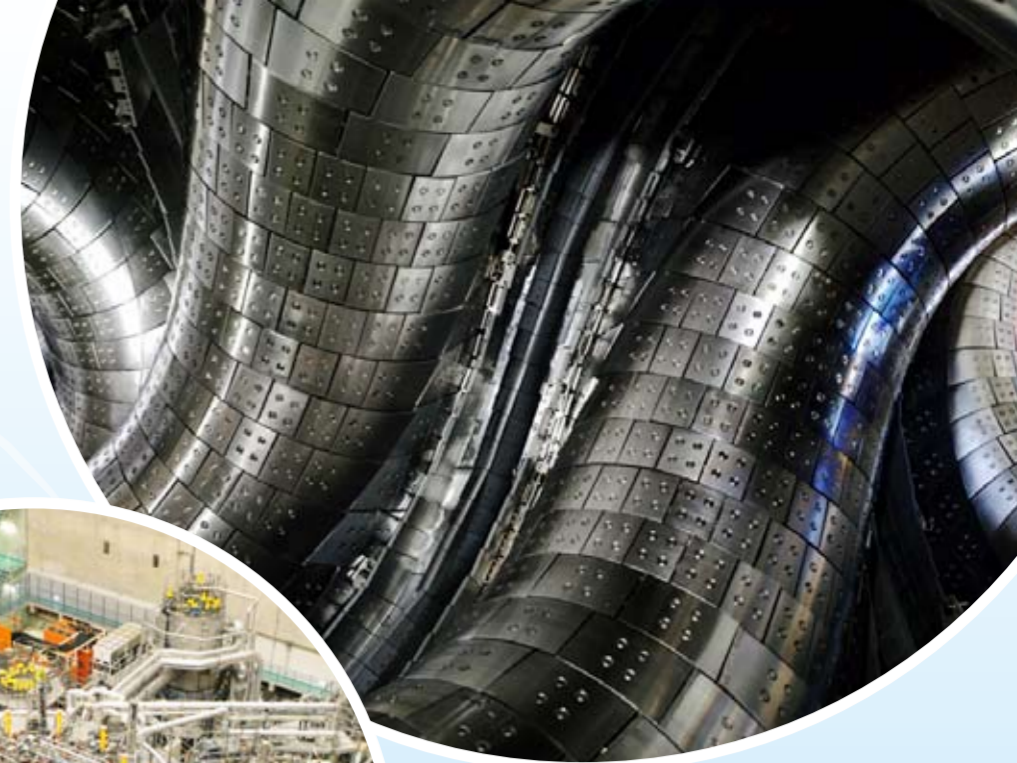
核融合プラズマ実験装置 「大型ヘリカル装置」の真空容器内部 (岐阜県土岐市)
